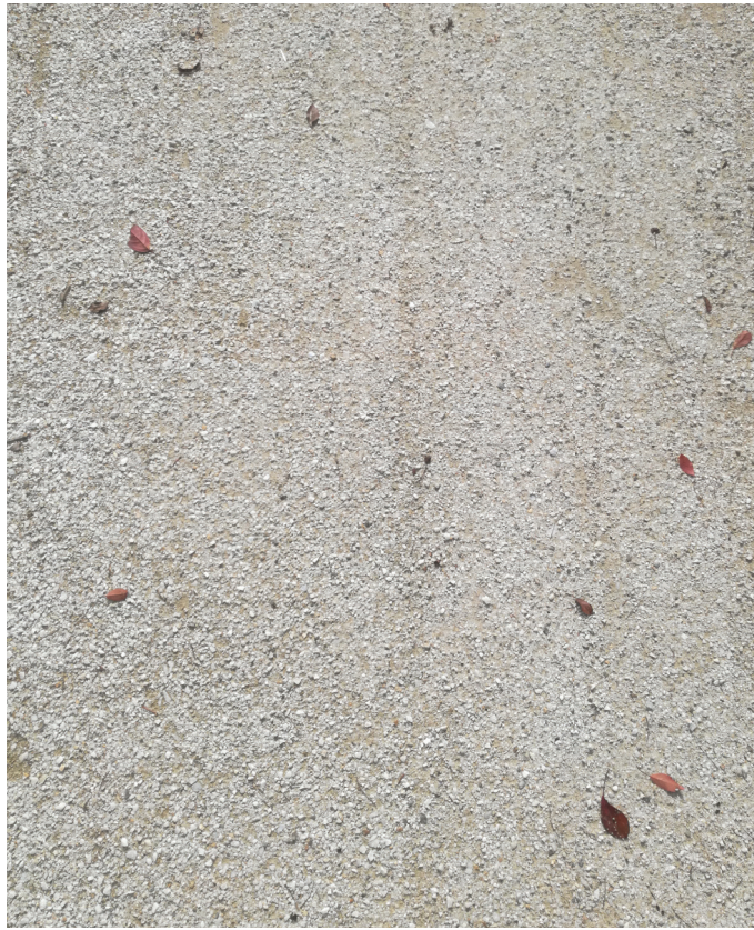
mechanicky zhutněné kamenivo
