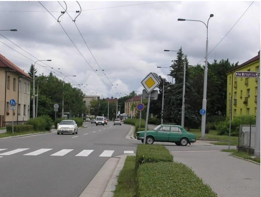
Ilustrační příklad: Pardubice, Dašická – ztratí-li infrastruktura pro cyklisty logickou vazbu s vozovkou, neplatí pro shodné rozlišení hlavní a vedlejší komunikace
