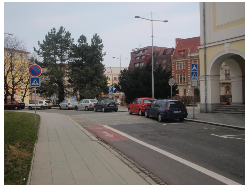
Vyhrazený jízdní pruh v cykloobousměrce s podélným parkováním.
